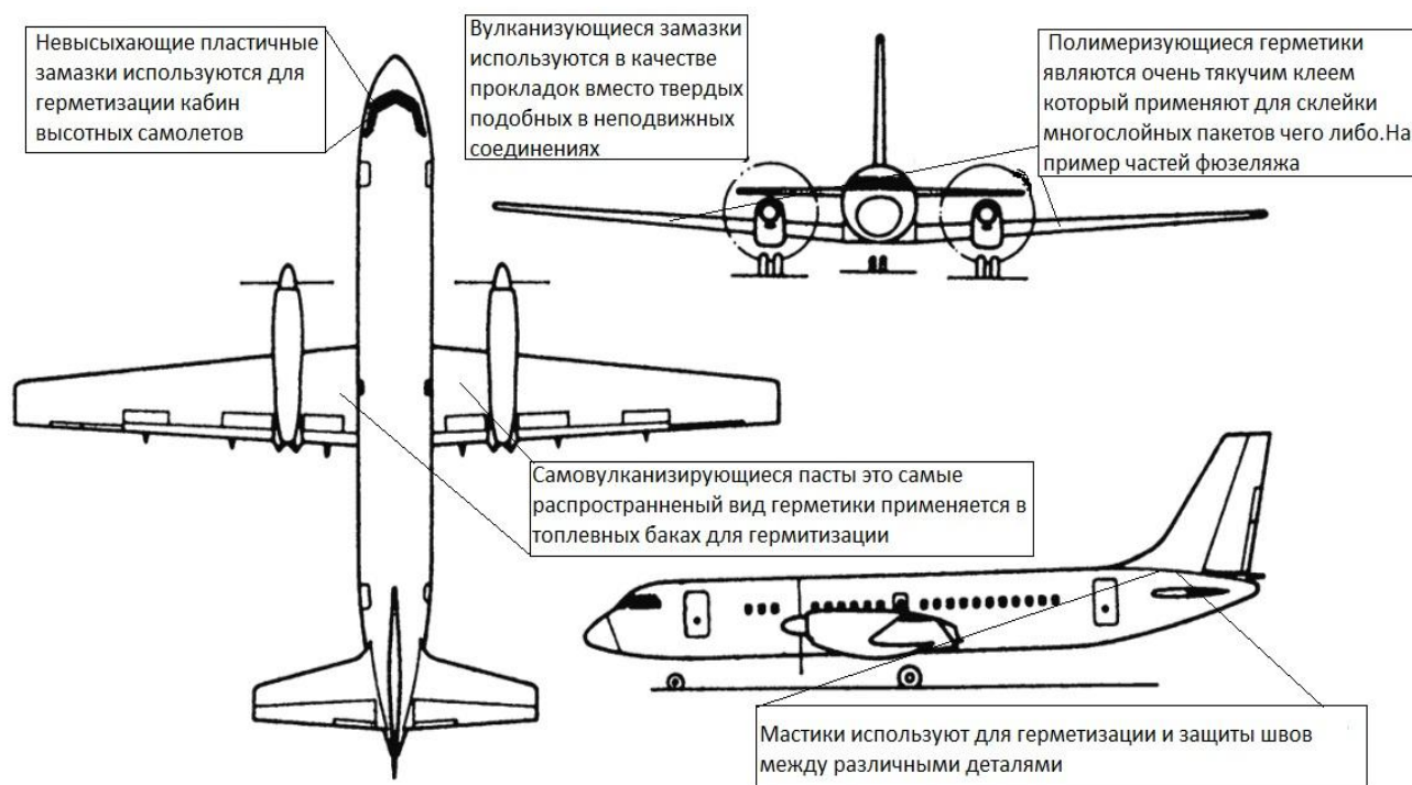
Рис. 1. Использование различных герметиков в частях самолетов
