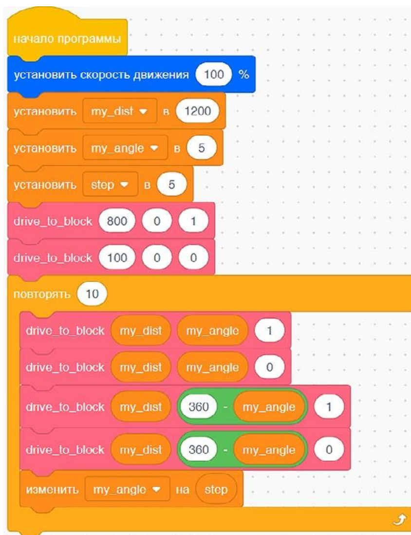
Рис. 71. Программа с шагом угла
