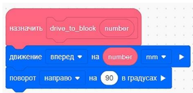
Рис. 62. Блок для перемещения VR-робота по полю
