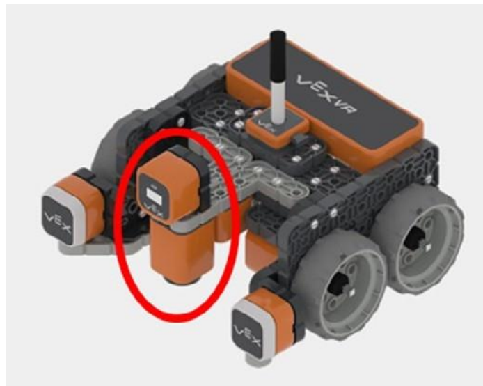
Рис. 30. Датчики цвета на VR-роботе
