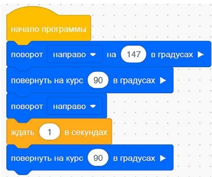
Рис. 66. Пример программы с использованием блока Поворот на курс
