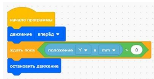
Рис. 23. Скрипт достижения VR-роботом координат Y > 0
