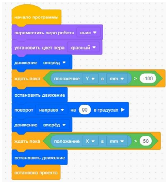
Рис. 12. Перемещение VR-робота по координатам
