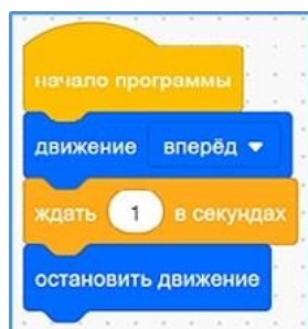
Рис. 42. Пример программы с использованием блока Ожидания
